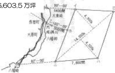
精度を高くするため、大正 15 年、会社は「角度法」による方法に変更申請し、許可されます。山見法によるものより面積が 1.8 倍になりました。どうやら始めの「山見法」による面積の数字が誤っていたようですが、縄張りを二倍近くに大きく変更したと地元の漁業組合の人々には不信感を募らせます。
